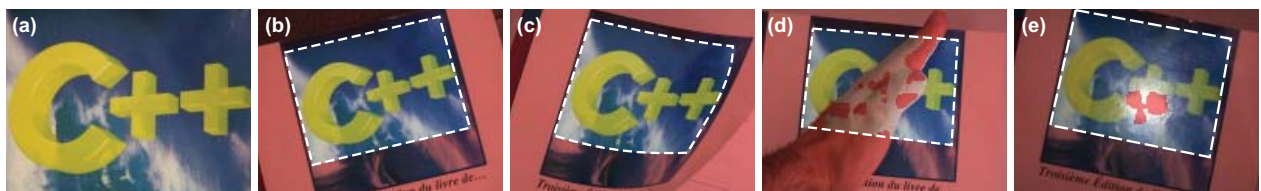
FIGURE 9 – Recalage d’un motif (a) avec notre algorithme dans différents contextes : scène rigide (b) ou déformable (c) et présence d’une occultation (d) ou d’une spécularité (e). Les pointillés blancs correspondent aux contours du motif recalé. La zone rouge, déterminée par notre algorithme, représente les pixels n’appartenant pas à la zone de recouvrement.
