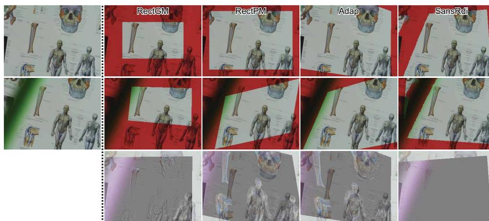
FIGURE 10 – Exemples de recalages pour différents algorithmes. La première et la deuxième lignes correspondent aux images source et cible respectivement. La dernière ligne représente l’image de différence entre l’image source et l’image cible transformée. Les parties rouges représentent les pixels n’appartenant pas aux chevauchements trouvés par les algorithmes.
